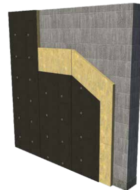
Sistema forrado para muros de mampostería.
